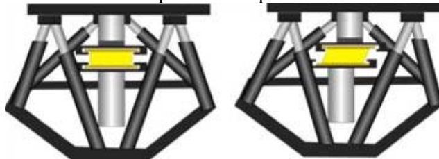
FIG. 5 – Vue schématique d'un essai de cisaillement sur l'hexapode.
