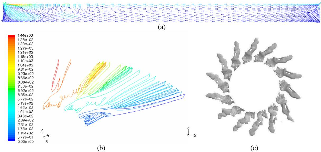
Fig. 2 – Résultats d'une simulation pour  $h=2\text{mm}$  ( $Bd=0.51$ ) et  $\Delta T = 5K$  ( $Ma=1468$ ) : (a) Vecteurs vitesses dans une coupe  $(r,z)$  de la cuve avec  $V_{MAX} = 2,2\text{ cm}\cdot\text{s}^{-1}$  en rouge, (b) Suivi temporel d'une particule (échelle en s) et (c) Iso-surface du gradient de température azimuthal  $\partial T / \partial \theta = 42\text{ K}\cdot\text{m}^{-1}$ .
