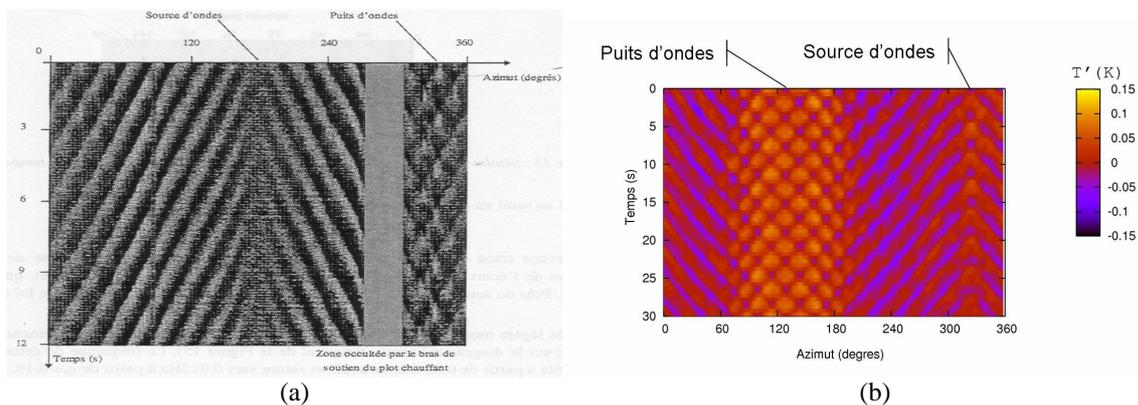
Fig. 3 – Diagramme spatio-temporels pour  $h=2\text{mm}$  ( $Bd=0.51$ ), (a) expérimental obtenu par ombroscopie dû à Favre (1997) ( $\Delta T$  inconnu) et (b) numérique pour  $\Delta T = 10K$  ( $Ma=2936$ ).
