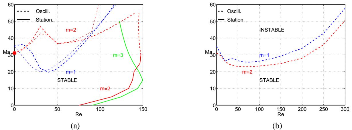
FIG. 2 – Courbes neutres ( $\lambda_r = 0$ ) dans le plan  $(Ma, Re)$  pour  $Pr = 0.02$ ,  $b = 1$ . Les traits pleins désignent une bifurcation stationnaire ( $\lambda_i = 0$ ) et les traits discontinus les bifurcations de Hopf ( $\lambda_i \neq 0$ ): (a) Contrarotation exacte  $s = -1$  traits épais et Isorotation  $s = 1$  traits fins (b) Rotor-stator  $s = 0$
