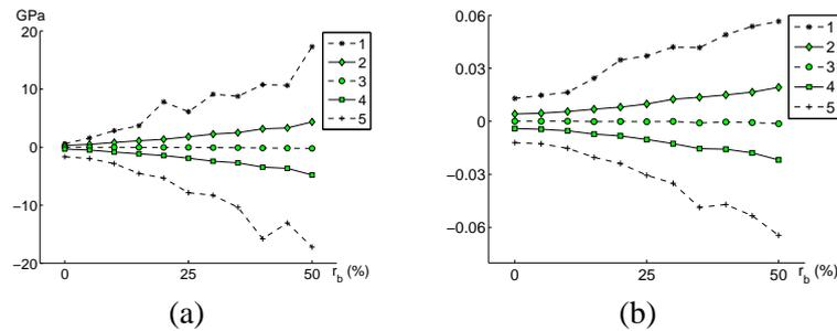
FIG. 3 – (a) : Détermination locale du module d'Young  $E$ , erreur maximale (1), moyenne + écart type (2), moyenne (3), moyenne - écart type (4), minimale (5); (b) : Détermination locale du coefficient de poisson  $\nu$ , erreur maximale (1), moyenne + écart type (2), moyenne (3), moyenne - écart type (4), minimale (5).
