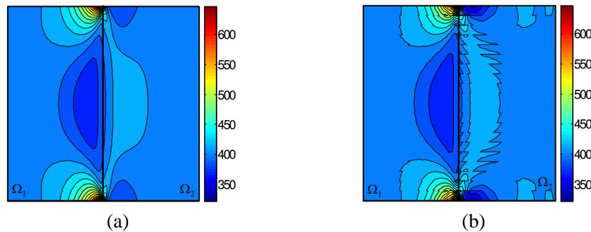
FIG. 5 – Pour le premier pas plastique (pas  $n = 2$ ) ; (a) : contrainte de traction donnée par le calcul direct en MPa ; (b) : contrainte de traction identifiée en MPa.
