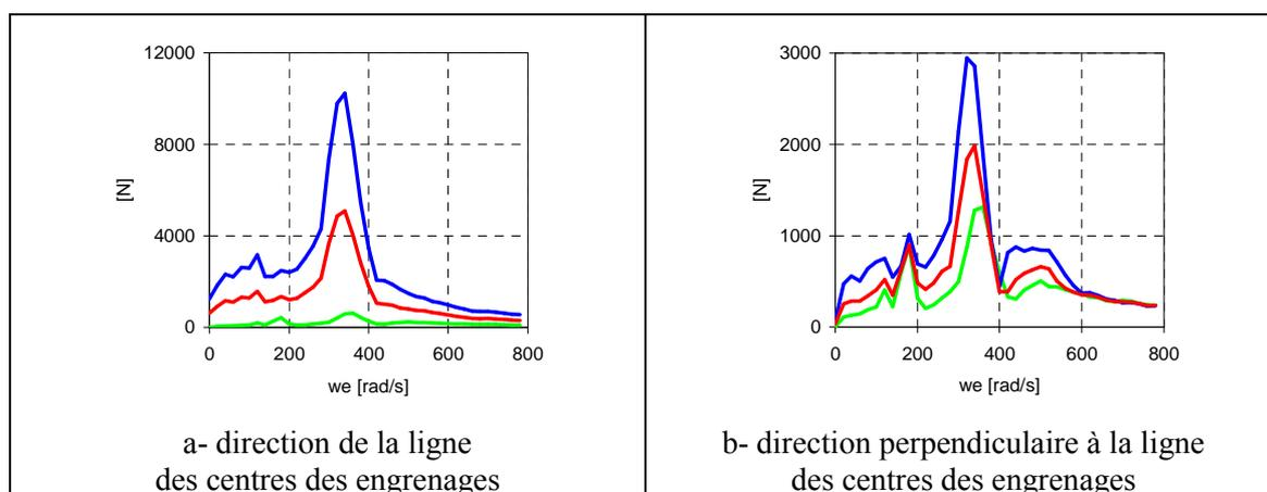
FIG. 5 – Fluctuation d'effort au palier. Dentures droites corrigées.
