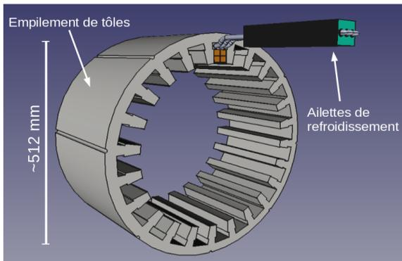
Figure 2 : Vue 3D de l'empilement de tôles comportant 24 encoches destinées à accueillir le bobinage et les assemblages caloducs. Pour ne pas surcharger la figure seule une encoche est complète.
