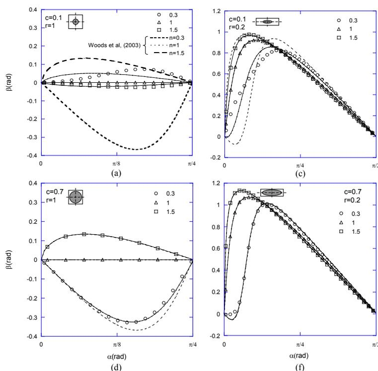
FIG. 5 – Evolution de l'angle  $\beta$  en fonction de  $\alpha$ , pour différentes valeurs de  $n$ , pour deux compacité ( $c = 0.7$  et  $0.1$ ) et pour deux rapports de forme ( $r = 1$  et  $0.2$ ). Les marques sont les résultats numériques obtenus. Les lignes et traits continus représentent les prévisions données par notre modèle et celui proposé par Woods et al. (2003).
