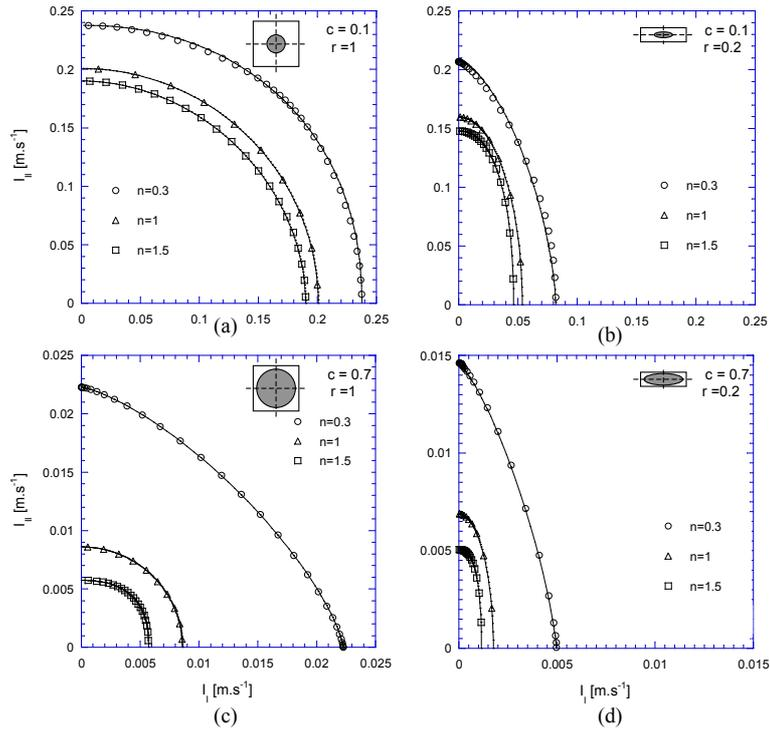
FIG. 2 – Courbes d'isodissipation mécanique obtenues pour deux compacités ( $c = 0.1$  et  $0.7$ ),  $l = 1$  m, deux rapports de forme ( $r = 1$  et  $0.2$ ),  $\mu_0 = 1 \text{ Pa s}^n$ ,  $\mathcal{P}_0 = 1 \text{ W m}^{-3}$ . Les marques représentent les résultats numériques. Les lignes continues sont l'ajustement de (8) avec les valeurs de  $m$  présentées dans la figure 3.
