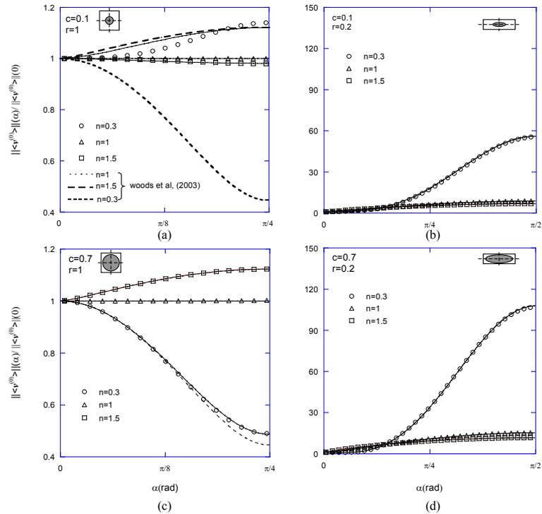
FIG. 4 – Evolution de  $\|\langle \mathbf{v} \rangle(\alpha)\|/\|\langle \mathbf{v} \rangle\|$  en fonction de  $\alpha$ , pour différentes valeurs de  $n$ , pour deux compacité ( $c = 0.7$  et  $0.1$ ) et pour deux rapports de forme ( $r = 1$  et  $0.2$ ). Les marques sont les résultats numériques obtenus. Les lignes et traits continus représentent les prévisions données par notre modèle et celui de Woods et al. (2003).
