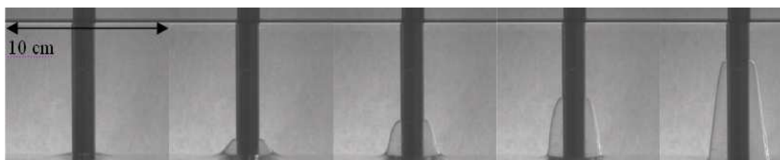
FIG. 2 – Visualisation par caméra de la déformation de l'interface PAAm 0.5% et Huile de silicone 100. De gauche à droite : 50, 100, 200, 300 et 400 \text{tr.min}^{-1} . D_{\text{axe}} = 10\text{mm} . V = 1\text{L} .
