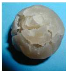
Figure 1 : Sphère de gel d'agar soumise à une déshydratation osmotique
