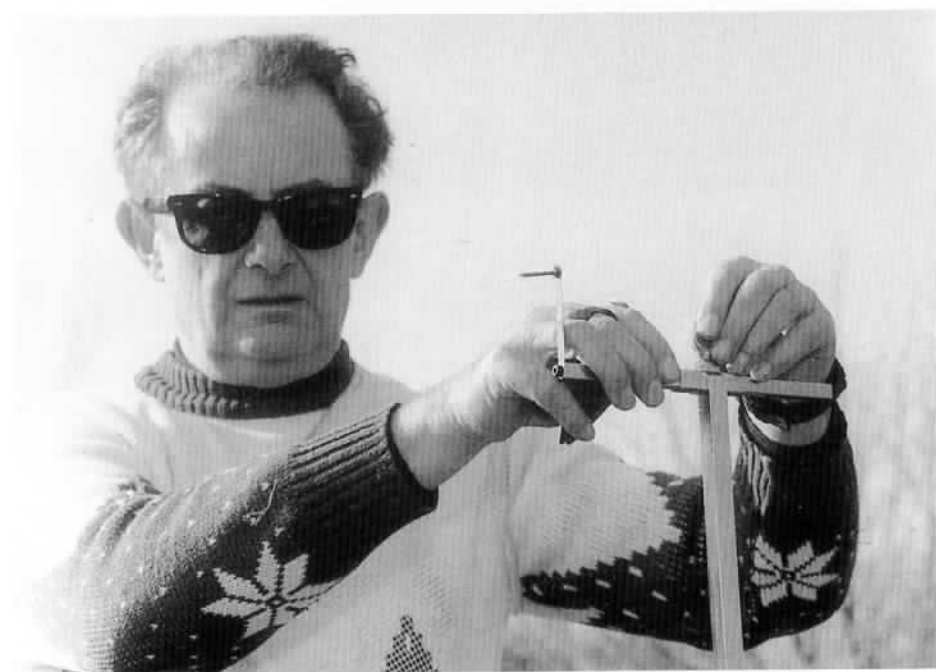
Photo N° 5 Réglage du viseur dans le sens horizontal.
