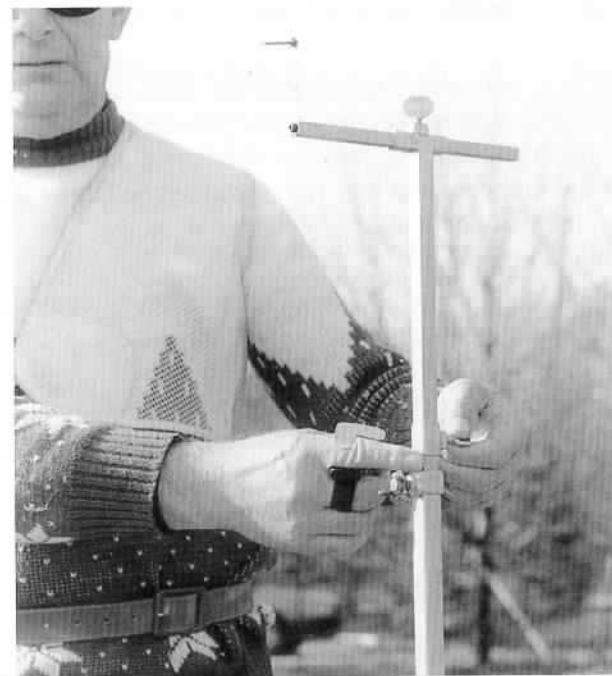
Photo N° 5 Réglage du viseur dans le sens horizontal.
