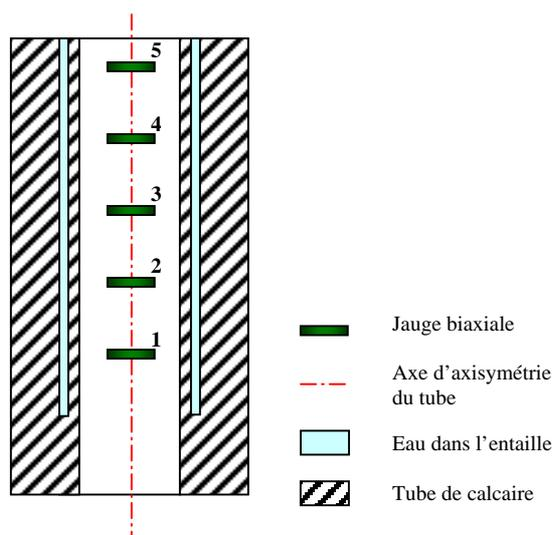
FIG.1 – Coupe longitudinale du tube de calcaire instrumenté.
