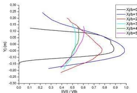
FIG 6 - Vitesse  $\|V\|/V_{th}$  dans le jet pour  $I = 10\%$ ,  $B = 2.7$  m,  $Z = 0.6$  m,  $Q = 736$  L/s
