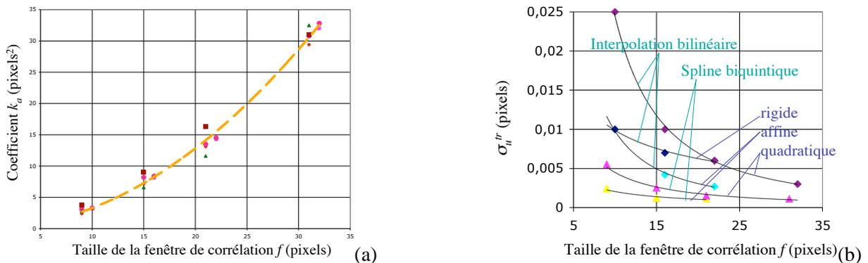
FIG. 4 – Valeur du coefficient  $k_a$  en fonction de  $f$  pour 5 logiciels de CIN supposant une transformation affine (a). Évolution de l'erreur pour un mouvement réel équivalent à une translation pure en fonction de  $f$  avec une hypothèse de transformation rigide, affine ou quadratique (b).
