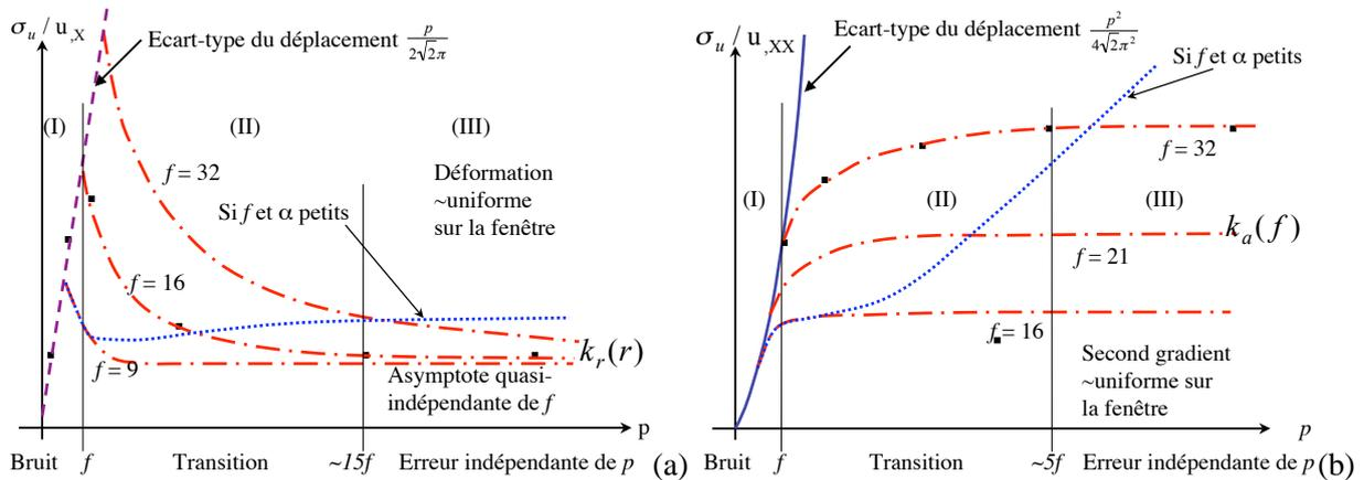
FIG. 3 – Évolution schématique de l'erreur quadratique  $\sigma_u$  en fonction de la période  $p$  du déplacement sinusoïdal en cas de fenêtre rigide (a) ou en transformation affine (b). L'erreur est normalisée par le gradient maximal en (a) et le maximum du second gradient en (b).
