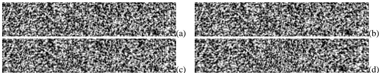
FIG. 2 – Extrait  $512 \times 100$  pixels de l'image de référence de définition intermédiaire (a) et des images déformées obtenues avec une période  $p$  de 30 (b), 130 (c) et 510 (d) pixels, l'amplitude  $\alpha$  valant 0,05.
