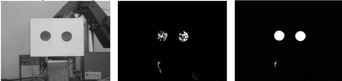
FIG. 4 – a) Sortie niveau de gris de la caméra, b) sortie de l'algorithme de groupement de couleur, c) la même image après clustérisations morphologique.
