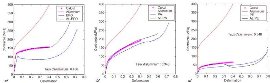
FIG. 5 – Résultats types de la modélisation d’une compression uniaxiale obtenus pour différents composites : a/ Al-Epoxyde b/ Al-PE et c/ Al-PA.
