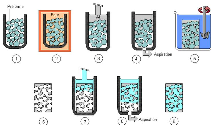
FIG. 1 – Procédé de fabrication des composites.
