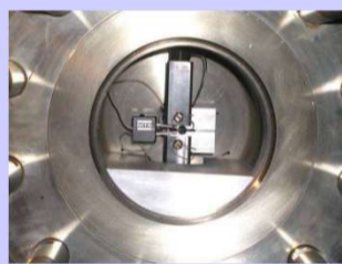
Détail du montage d'une éprouvette de type CT avec extensomètre COD
