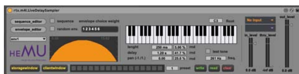
Figure 19. Dispositif Max For Live pour la resynthèse granulaire en temps réel contrôlée par notes MIDI.
