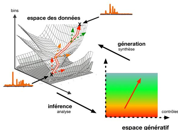
**Figure 1.** Dans cette méthode, nous proposons d'utiliser des méthodes d'extraction de sous-variétés non-linéaires inversibles dans l'espace de données, ici des informations spectrales, pour *inférer* un espace *génératif* pouvant être utilisé pour contrôler la génération sonore.
