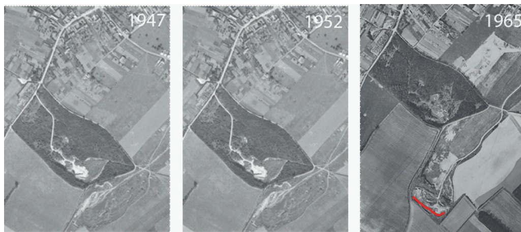
Fig. 7 - Évolution de l'exploitation de la carrière. 1. Vue aérienne de 1947. 2. Vue aérienne de 1952. 3. Vue aérienne de 1965 (photos aériennes IGN*). En rouge = front de taille de l'argillère Mouly. * site IGN Remonter le temps.
