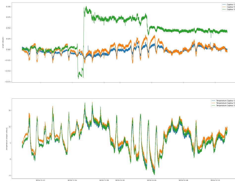
FIGURE 5: Valeurs d'inclinaison (en haut) et de température (en bas) mesurées par les capteurs 1, 32 et 57 en fonction du temps. Le capteur 32 enregistre des sauts d'inclinaison dus à l'affaissement de la voie, mais les trois capteurs ont des oscillations journalières, fortement corrélées avec la température.
