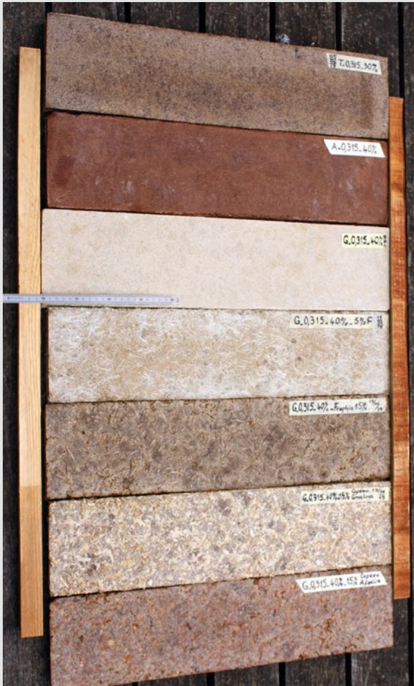
Photo 3. Exemples de mise en oeuvre de CBPo : panneaux à base de sciure de différentes essences de bois. Examples of CBPo implementation: sawdust-based panels of different wood species.
