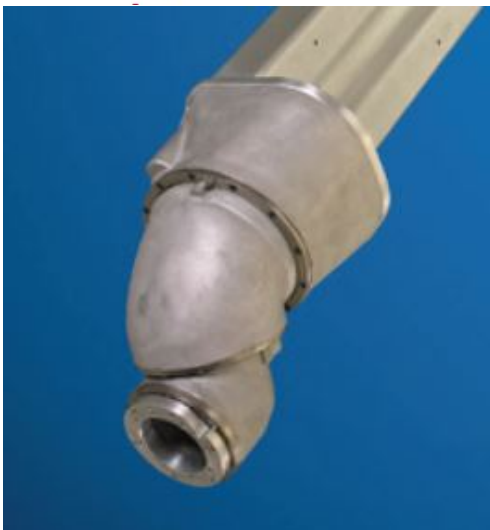
Figure 22 – Deux robots industriels 6R avec offset au poignet : le robot GMF P150 (en haut) et le robot Fanuc P250iB (au centre). Détail sur le poignet à offset (en bas).
