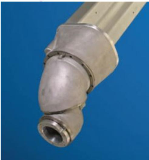
Figure 22 – Deux robots industriels 6R avec offset au poignet : le robot GMF P150 (en haut) et le robot Fanuc P250iB (au centre). Détail sur le poignet à offset (en bas).
