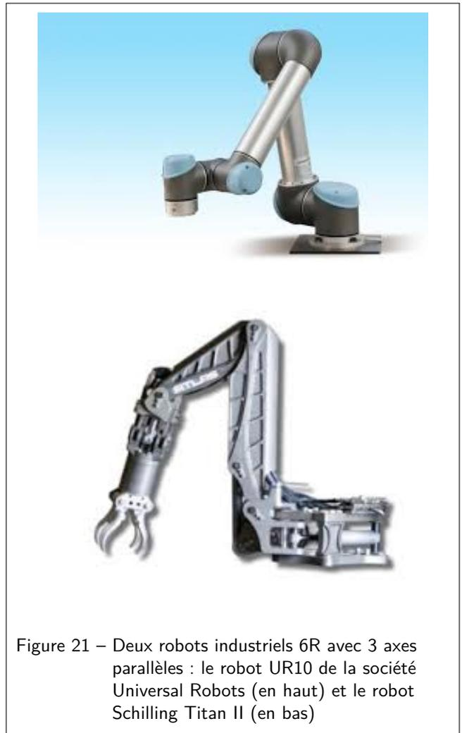
Figure 21 – Deux robots industriels 6R avec 3 axes parallèles : le robot UR10 de la société Universal Robots (en haut) et le robot Schilling Titan II (en bas)
