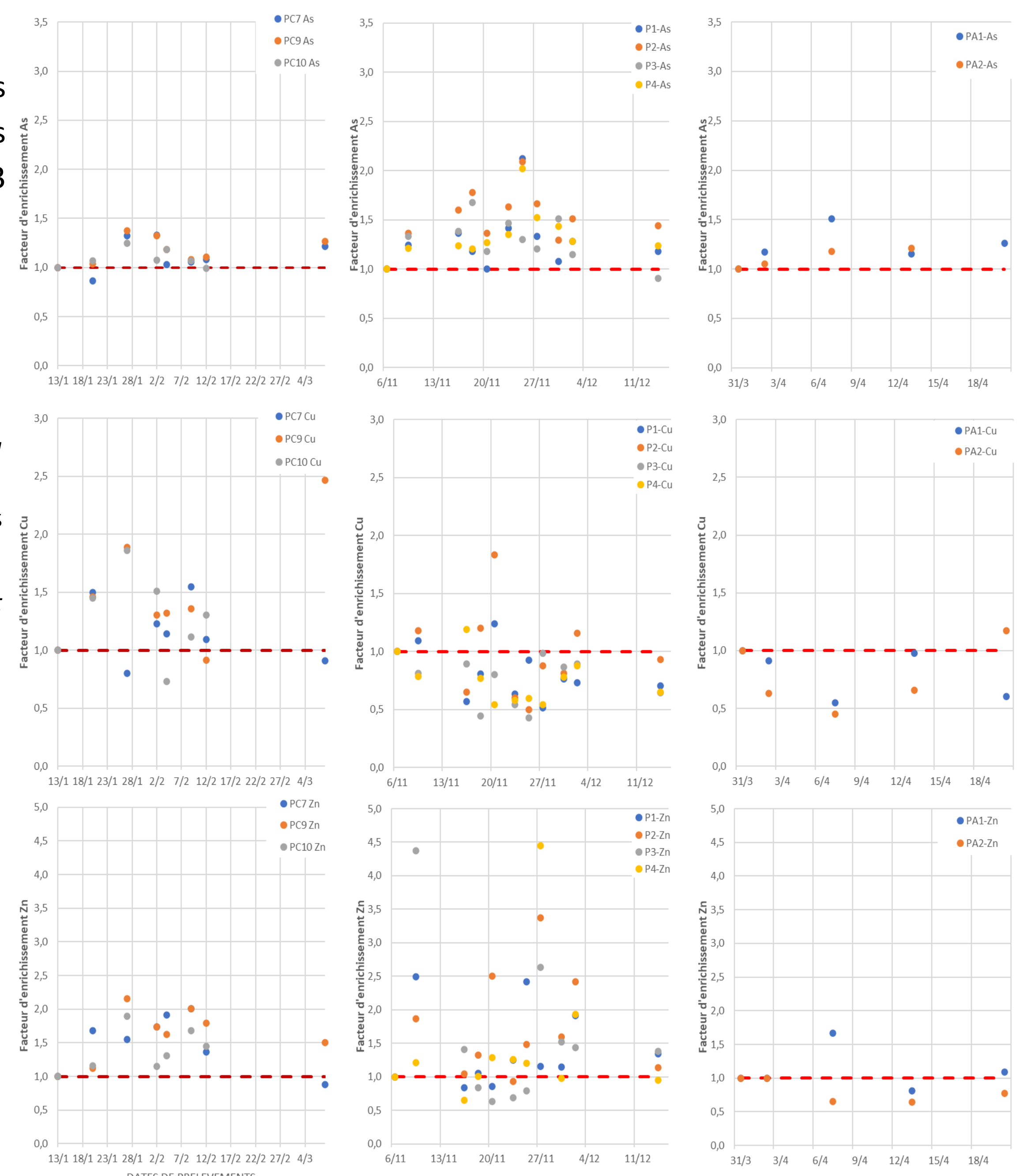
Figure 4 : Facteurs d'enrichissement en As, Cu et Zn calculés au cours des dragages de Port-Camargue (PC), Pérols (P) et Palavas (PA)
