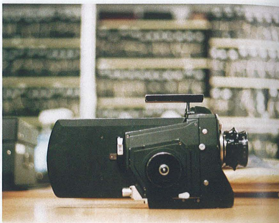
La caméra 8-35, vue côté moteur, avec sa valise. Photographie prise au Conservatoire des techniques de la Cinémathèque française, BNF - Photo Valentina Miraglia.
