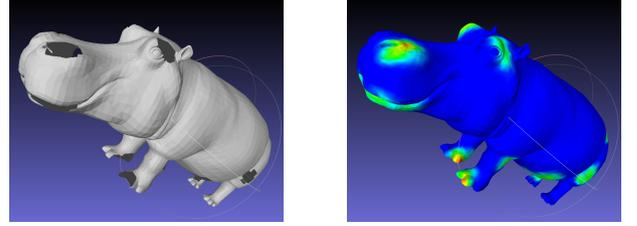
FIGURE 3 – Modèle 3D troué et la réponse locale de la métrique MSDM2.
