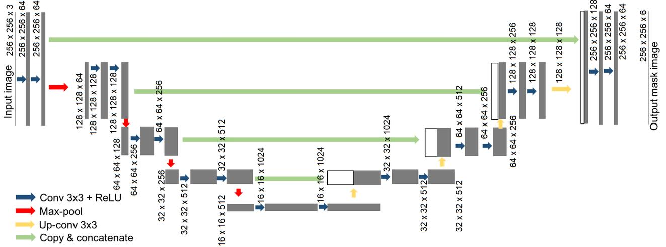
FIGURE 2 – Architecture d’un réseau U-Net [6].
