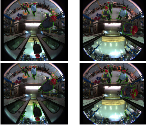
FIGURE 4 – Première ligne : résultats d’inférence avec resnet101 Mask R-CNN. Deuxième ligne : résultats d’inférences avec resnet101 Mask R-CNN avec augmentation 35FE.
