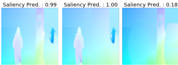
FIGURE 3 – Impact des régions sur la prédiction de classification de saillance dynamique. En partant du flot optique (à gauche), nous remplaçons le flot dans les régions sélectionnées en utilisant la technique d’inpainting décrite à la section 2.5. Lorsque la région du tronc d’arbre au premier plan est ainsi inpaintée, l’image est toujours classée comme dynamiquement saillante (au milieu). En revanche, l’inpainting des régions correspondant aux deux personnes en mouvement fait alors passer l’image dans la classe des images dynamiquement non saillante (à droite). Voir le score de prédiction au-dessus de chaque image.
