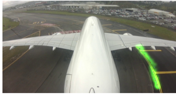
FIGURE 5 – Déplacement de la région d’intérêt définie selon la vraisemblance des particules pour la détection d’une ligne. La position de la particule avec le plus grand poids est affichée
