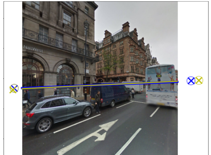
Figure 1: Estimation de la ligne d’horizon et détection des points de fuite. En jaune : sortie des réseaux. En bleu : vérité terrain.
