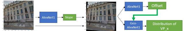
Figure 8: Détection de la ligne d'horizon et des points de fuite basée sur la géométrie (FULL).
