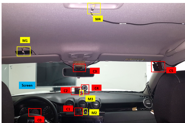
FIGURE 1 – Vue intérieure de l'habitacle de la voiture avec le matériel d'enregistrement et les capteurs.
