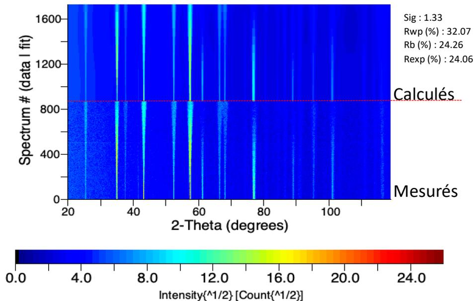
**Figure 2.** Diffractogrammes du Corindon 1976a du NIST mesurés sur un diffractomètre Inel-ThermoFisher 4-cercles pour 850 orientations ( $\chi, \varphi$ ) de l'échantillon, affinés à l'aide du logiciel MAUD
