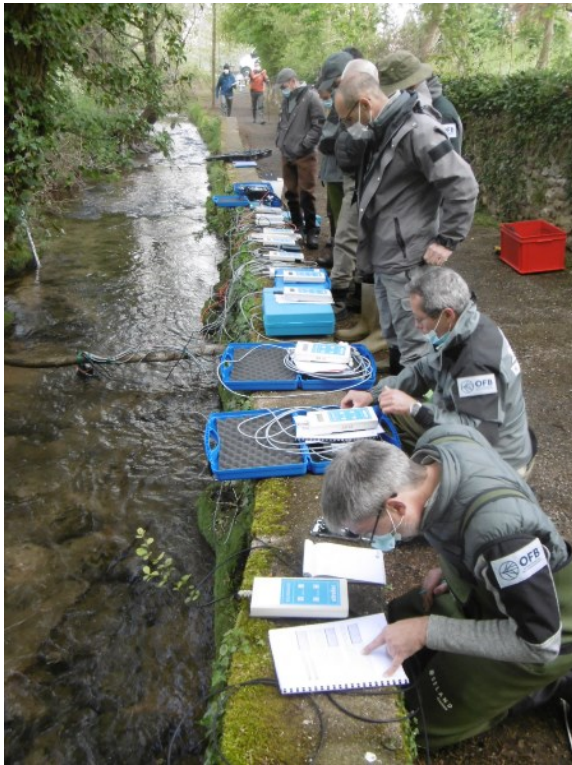
Figure 5 : Tronçon de mesure aval et transect de jaugeage ADV.
