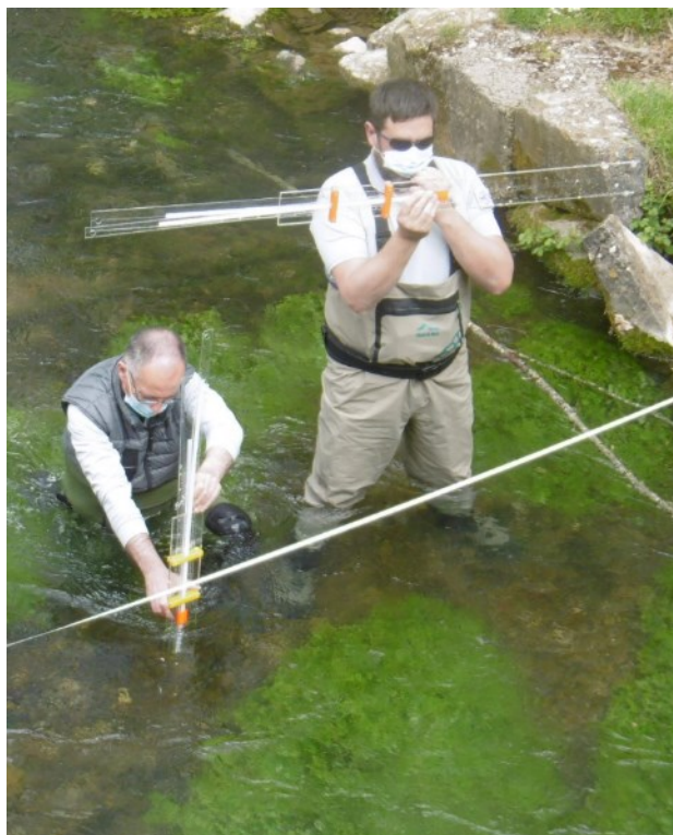
Figure 11 : Perche dynamique transparente en position de mesure à gauche puis en position de lecture de la charge à droite.
