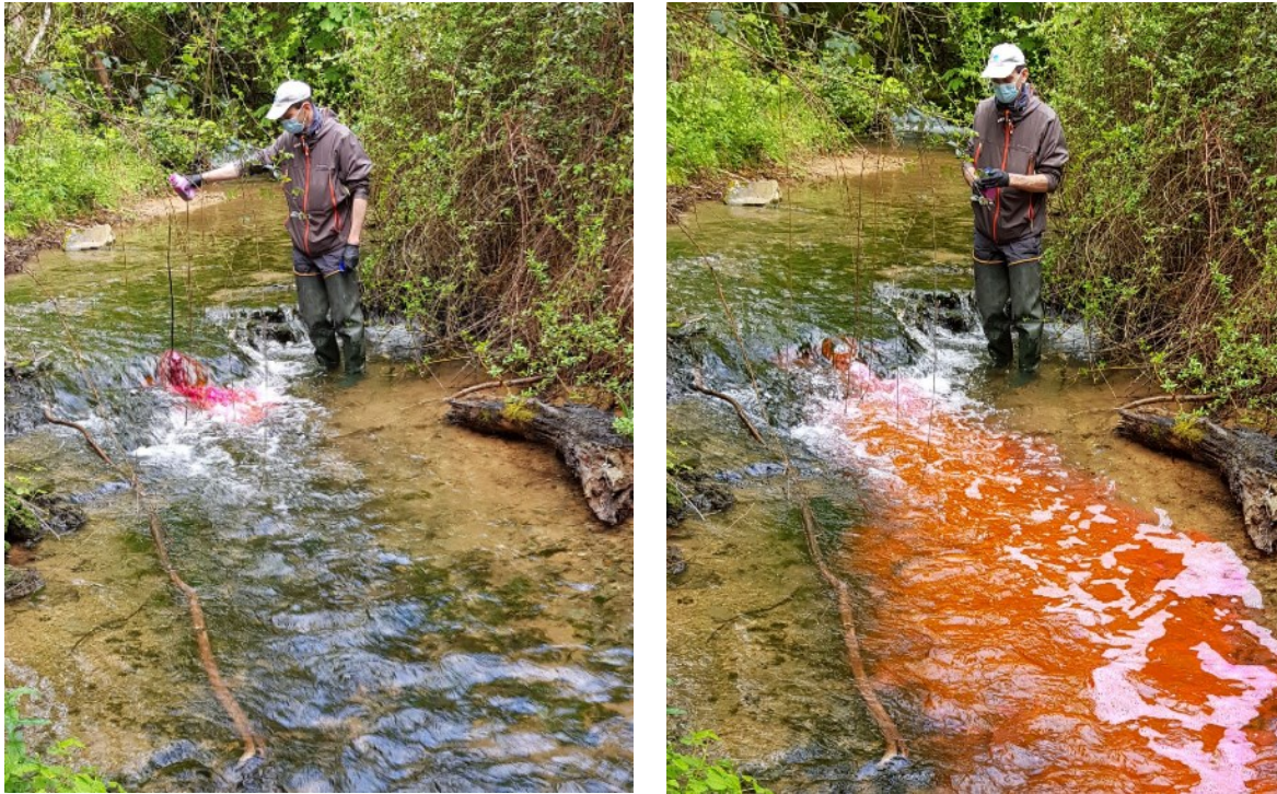
Figure 4 : Estimation de la distance de bon mélange avec l'injection de Rhodamine WT
