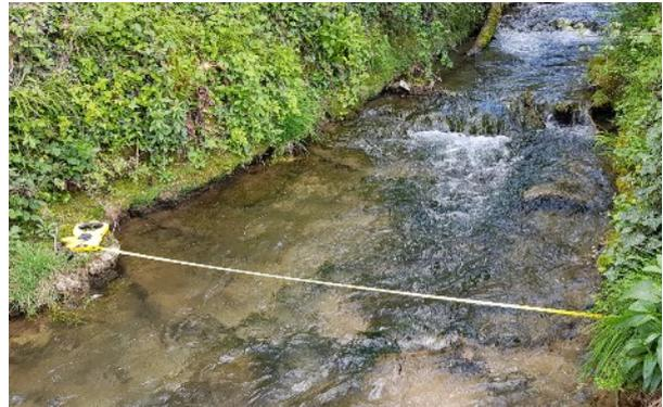
Figure 5 : Tronçon de mesure aval et transect de jaugeage ADV.
