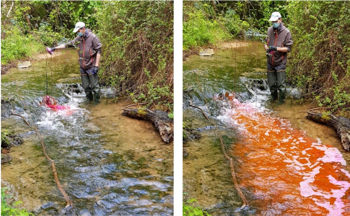
Figure 4 : Estimation de la distance de bon mélange avec l'injection de Rhodamine WT
