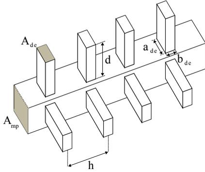
FIGURE 1 – Pore principal de section carrée  $A_{mp}$  avec l'arrangement périodique de pores dead-end;  $N = 2$  pores dead-end de section rectangulaire  $A_{de}$  et de longueur  $d$  par période  $h$
