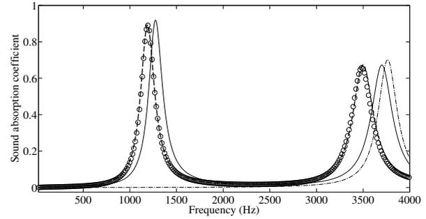
FIGURE 2 – Coefficient d'absorption d'un échantillon d'épaisseur 22.5 mm composé de  $N_C = 10$  cellules. Modèle TMM (○); approximation basses fréquences (- - -); simulation FEM (—); absorption sans pores dead-end (- · -)
