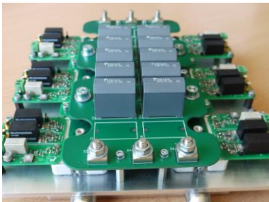
Fig. 10. Onduleur 10kW réalisé pour valider les modèles
