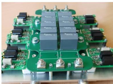
Fig. 10. Onduleur 10kW réalisé pour valider les modèles
