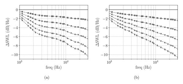
Figure 24: Predictions using Posson's model with Kerschen and Gliebe's spectrum  $(l_a/l_t > 1)$ . SWL difference with respect to the isotropic case  $(l_a = l_t)$ .  $l_a = l_t$  (---),  $l_a = 1.1l_t$  (---),  $l_a = 1.2l_t$  (---),  $l_a = 1.3l_t$  (---),  $l_a = 1.3l_t$  (---),  $l_a = 1.3l_t$  (---),  $l_a = 1.5l_t$  (---). (a) Upstream  $\triangle$ SWL, (b) Downstream  $\triangle$ SWL.
