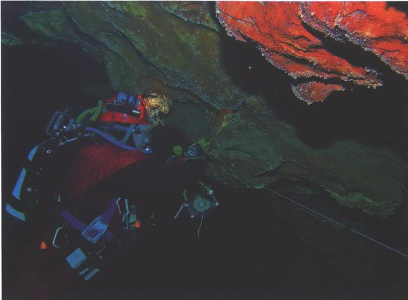
Photo 5 : Pose du fil pour la topographie dans le siphon. Chaque point est doté d'une étiquette numérotée qui permet de l'identifier sous l'eau.
