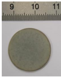
Figure 5 : Substrat AlN_Filcera de diamètre 20 mm, et d'épaisseur 1,27 mm, après amincissement par polissage.
