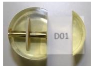
Figure 8 : Échantillon encapsulé, après démoulage et découpe de l'excédent de résine, permettant la prise de contact électrique. (Vue de dessus dans la direction verticale du coulage de la résine).
