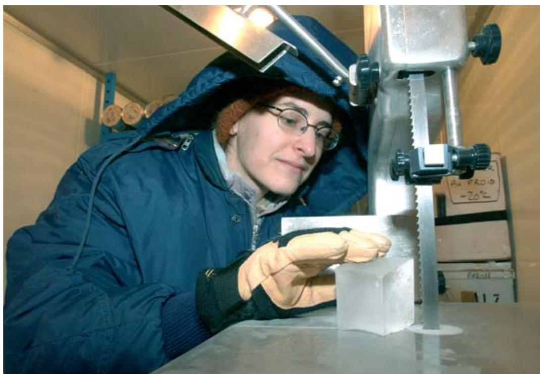
Les échantillons de glace sont découpés en chambre froide (-20 °C) avant de procéder à l'analyse des bulles d'air qui y sont piégées.
