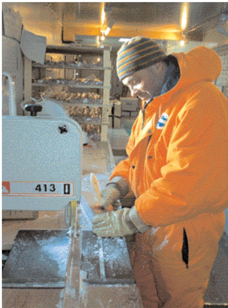
Après extraction des carottes de glace, des échantillons sont découpés et préparés pour des analyses ultérieures en Europe. De nombreuses analyses sont également réalisées en continu sur le terrain.
