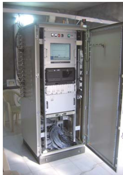
L'instrument de mesure du CO 2 baptisé Caribou.
