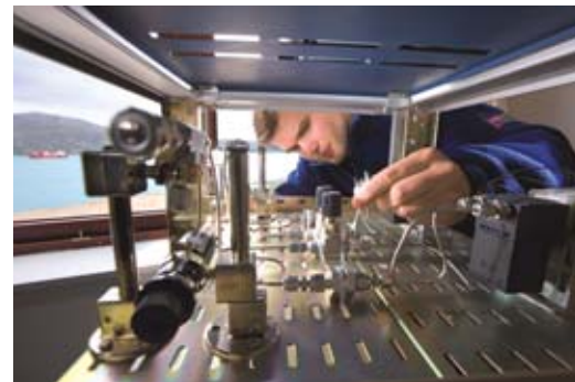
Connexion de la ligne d'air sur le dispositif de mesure de l'oxygène atmosphérique.
