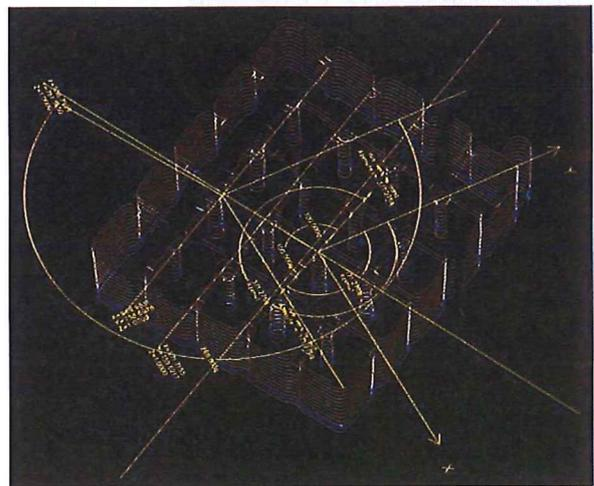
**Figure 17** : Exemple des nuages de points du sondage ouest, état à l'issue de la campagne de fouille 2008, après leur géoréférencement et leur traitement. Neuf stations ont été nécessaires. L. Borel ©CEAlex.
