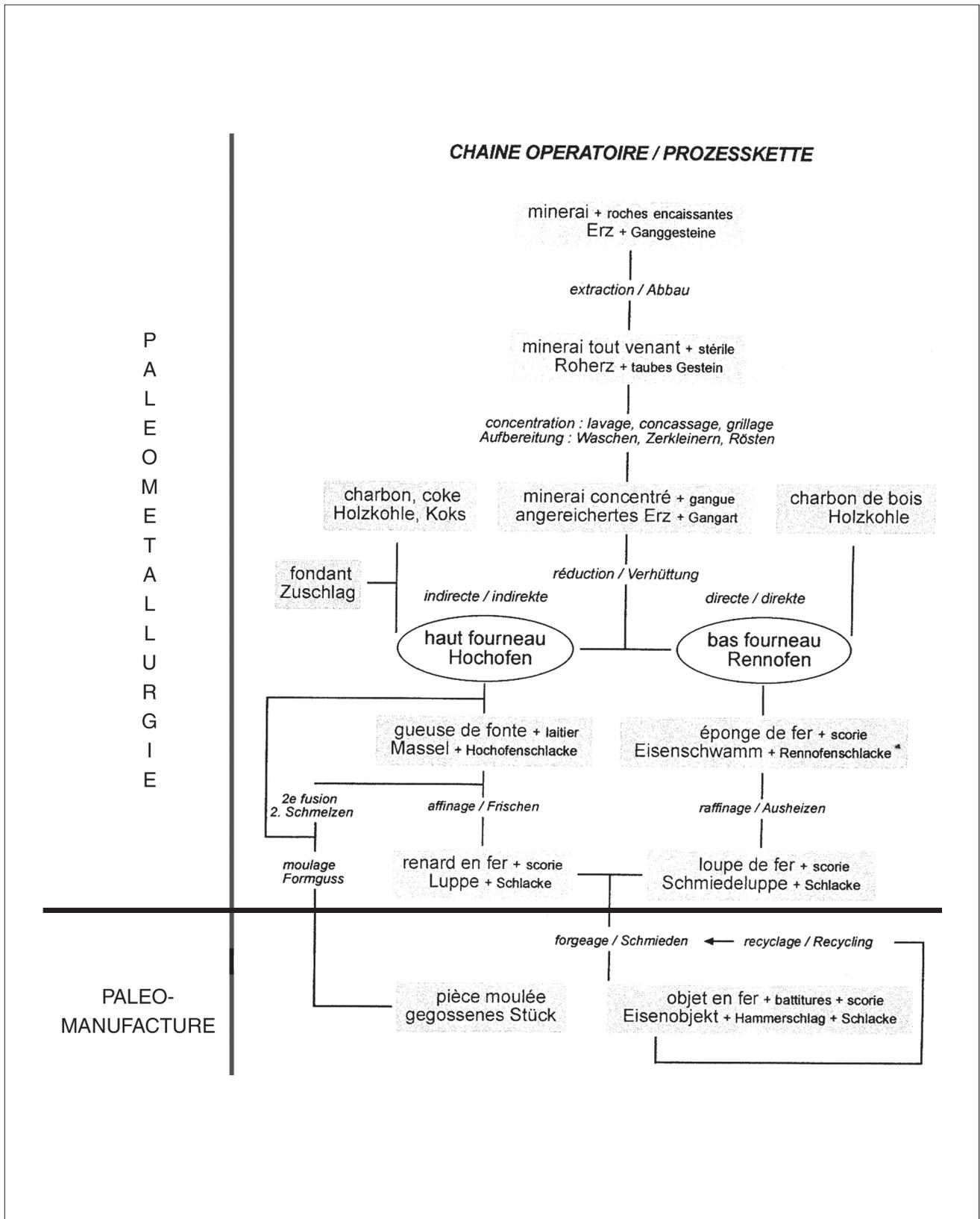
Fig. 24. VATG-ASTFA 1997. La chaîne opératoire décrite dans le volume page 8. Nous y avons ajouté deux traits noirs pour séparer les deux métiers confondus dans cet ouvrage : la paléoméallurgie et la paléomanufacture.
