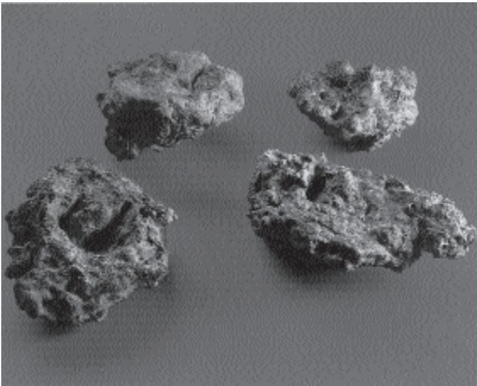
Fig. 38. La scorie de fer en forme de calotte produite dans les forges (Anderson et al. 2001, p. 8 ; VAGT-ASTFA, 1997, p. 35).
