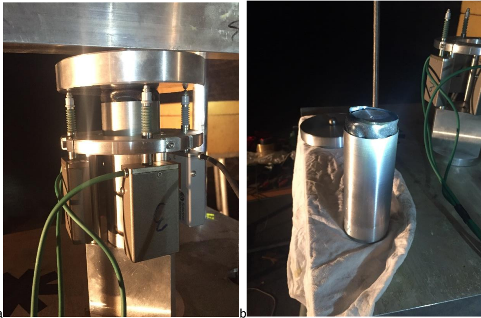
Figure 49 : a : montage avec la Jaquette en néoprène remontant le long du talon supérieur pour L'éprouvette I1 b : démontage en cours, jaquette remontée et boudinée autour du talon haut.
