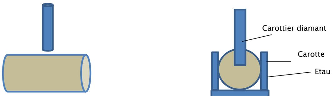
Les faibles aires de contact des mâchoires de l'étau et de l'attaque initiale du carottier peuvent poser des problèmes et amorcer des fissures.
