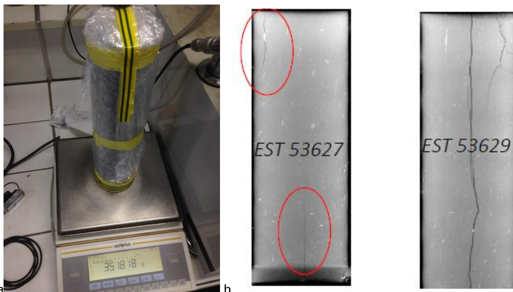
Fig. 5. a : Pesée de carottes avant et après scans RX. b : Mise en évidence de fissures préexistantes dans les carottes initiales à la sortie des cellules EST 53627 et EST 53629 (très fissurée). Prélèvement de 3 échantillons de 36 mm et 19 échantillons de 8 mm dans EST 53627 (série G) et EST 53629 (série H).
