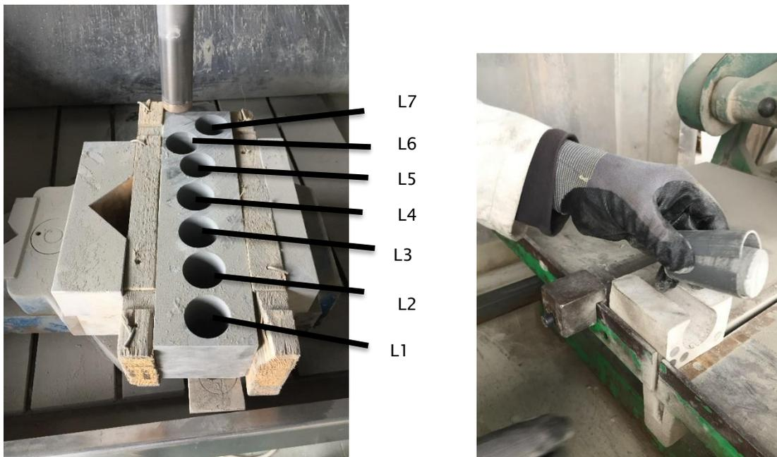
Cellule Est57904 rectifiée en parallélépipède avant carottage. Emplacement des éprouvettes de la série L. Noter que L6 et L7 sont proches des bords. B : Découpe des éprouvettes carottées dans Est57904 à la scie diamantée. Les éprouvettes sont maintenues dans un bloc de grès, qui a été foré à un diamètre équivalent plus une épaisseur de tube PVC.
