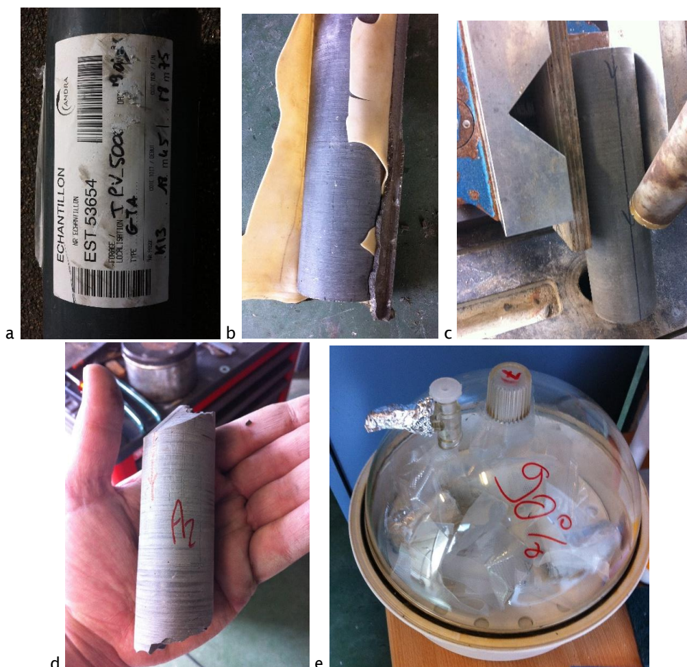
Fig. 1. Préparation des échantillons : Ouverture de cellule T1 (a, b), carottage orienté en diamètre 36 mm (c,d), rectification et conditionnement (aluminium-paraffine-poche à vide) et stockage en dessiccateur à solution saline (e).
