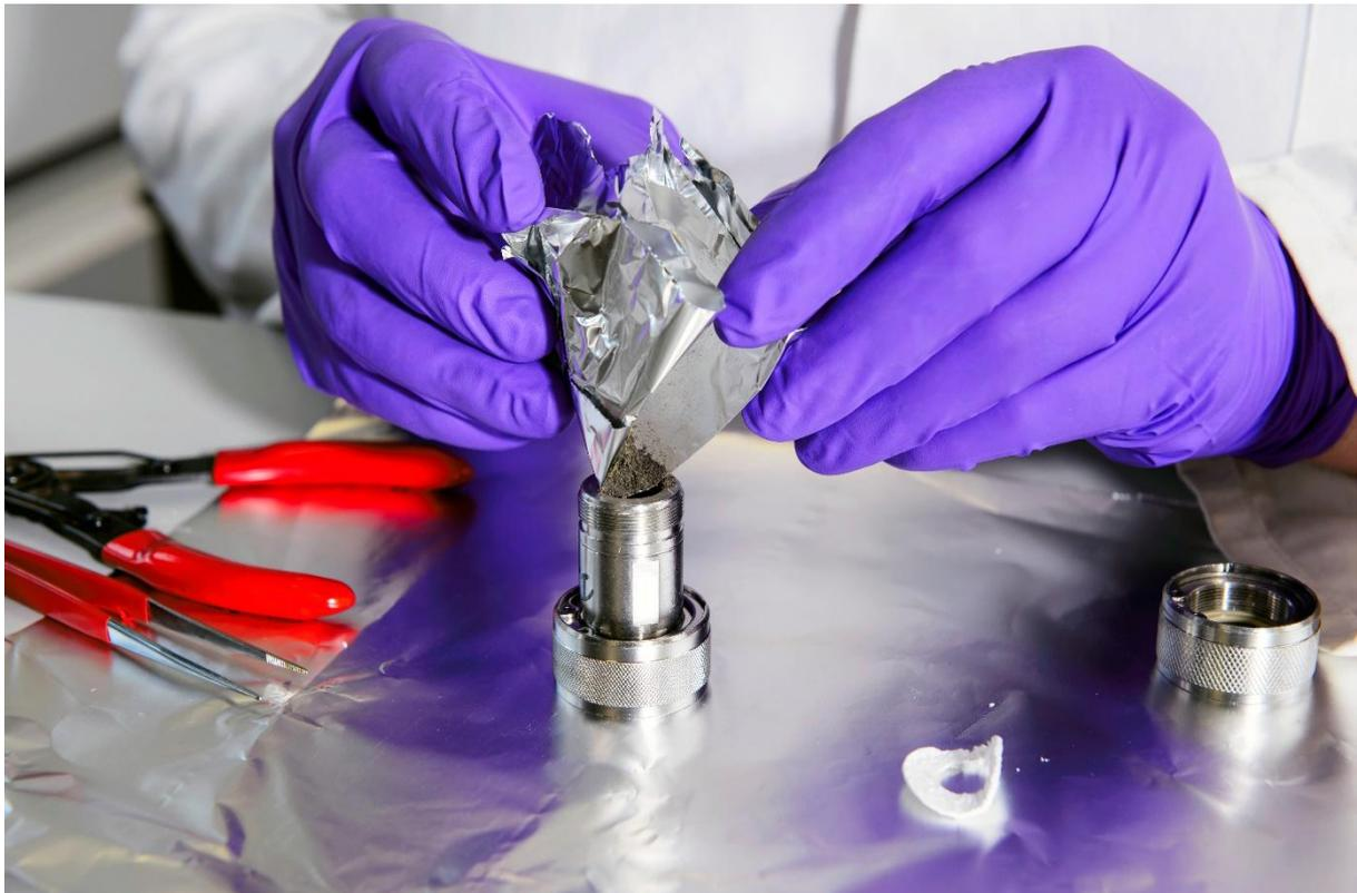
Préparation de l'extraction des biomarqueurs d'un échantillon de sédiments, issu d'une carotte prélevée dans la chambre à sable, en prévision de leur analyse. ©Cyril Frésillon, CNRS IMAGES
