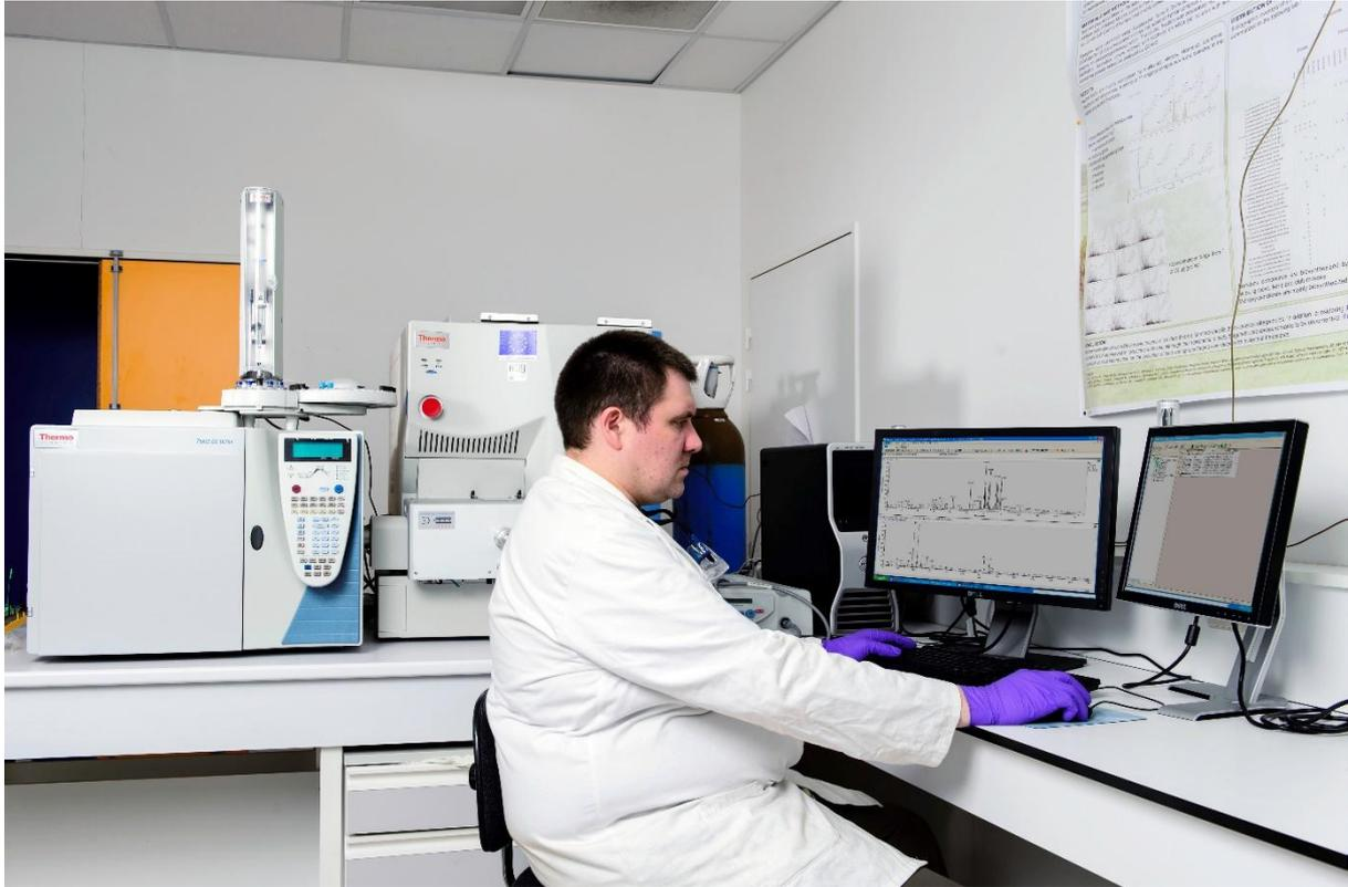
Dépouillement des résultats de l'analyse par chromatographie en phase gazeuse et spectrométrie de masse de la composition en biomarqueurs et polluants extraits de sédiments issus de la carotte prélevée dans la chambre à sable. ©Cyril Frésillon, CNRS IMAGES
