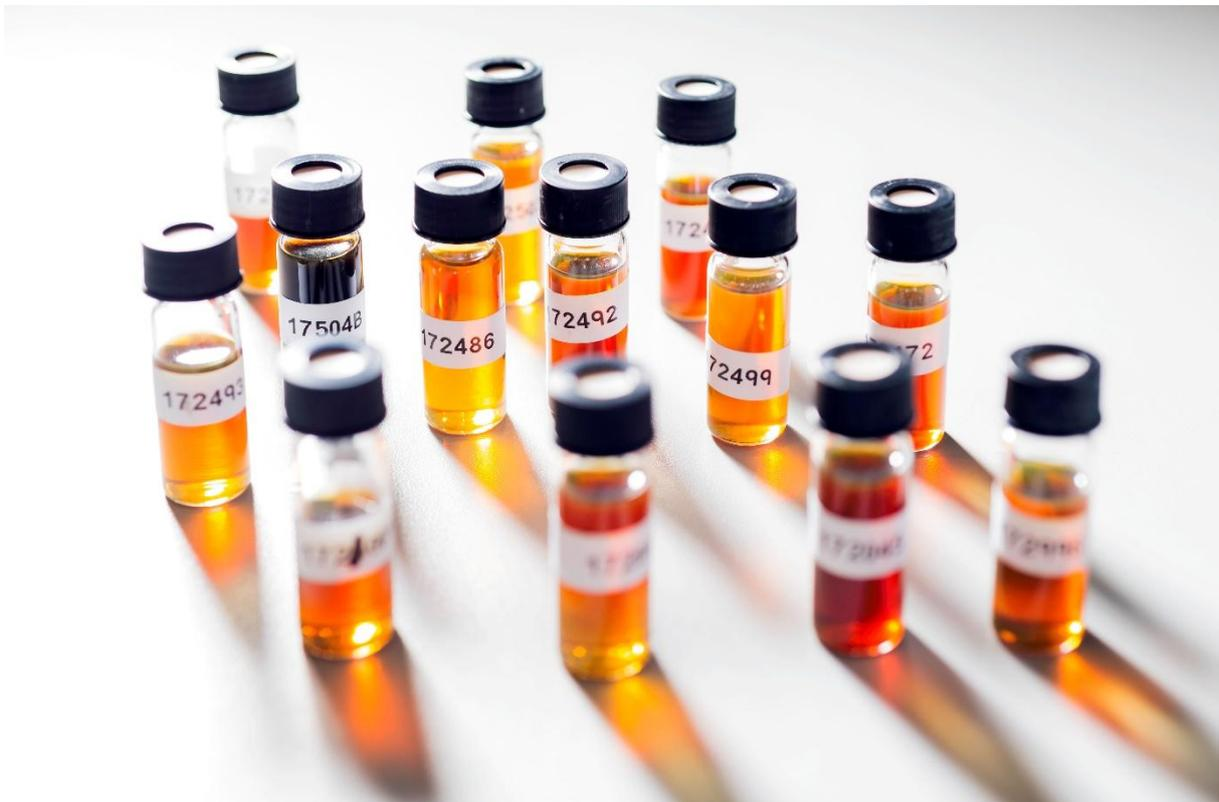
Extraits organiques d'échantillons de sédiments prélevés dans une carotte extraite dans la chambre à sable. L'analyse de ces extraits (composition en biomarqueurs moléculaires et polluants) sera réalisée par chromatographie en phase gazeuse et spectrométrie de masse. ©Cyril Frésillon, CNRS IMAGES
