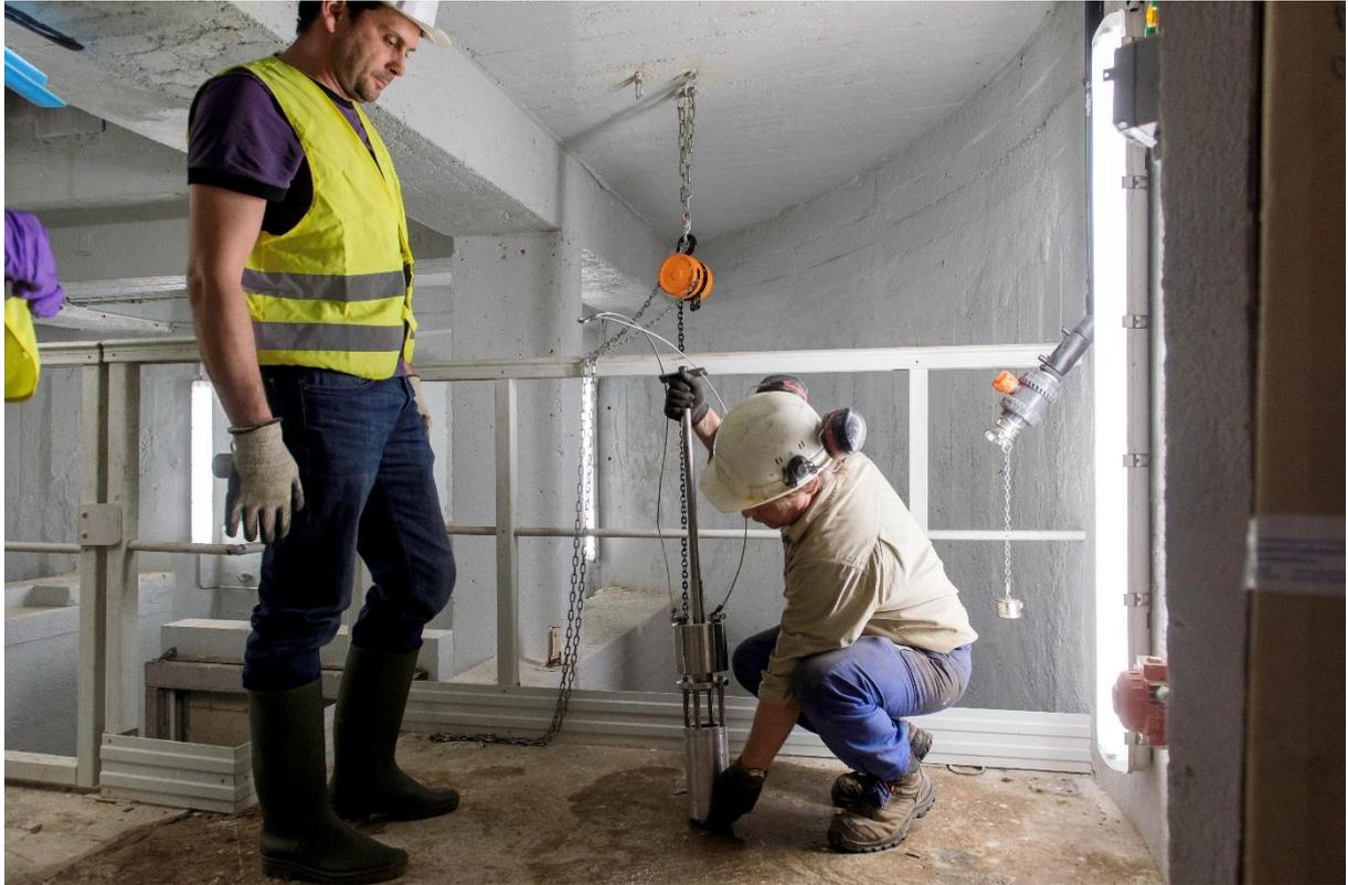
Préparation d'un carottier gravitaire pour le prélèvement de sédiments dans la chambre à sable. ©Cyril Frésillon, CNRS IMAGES
