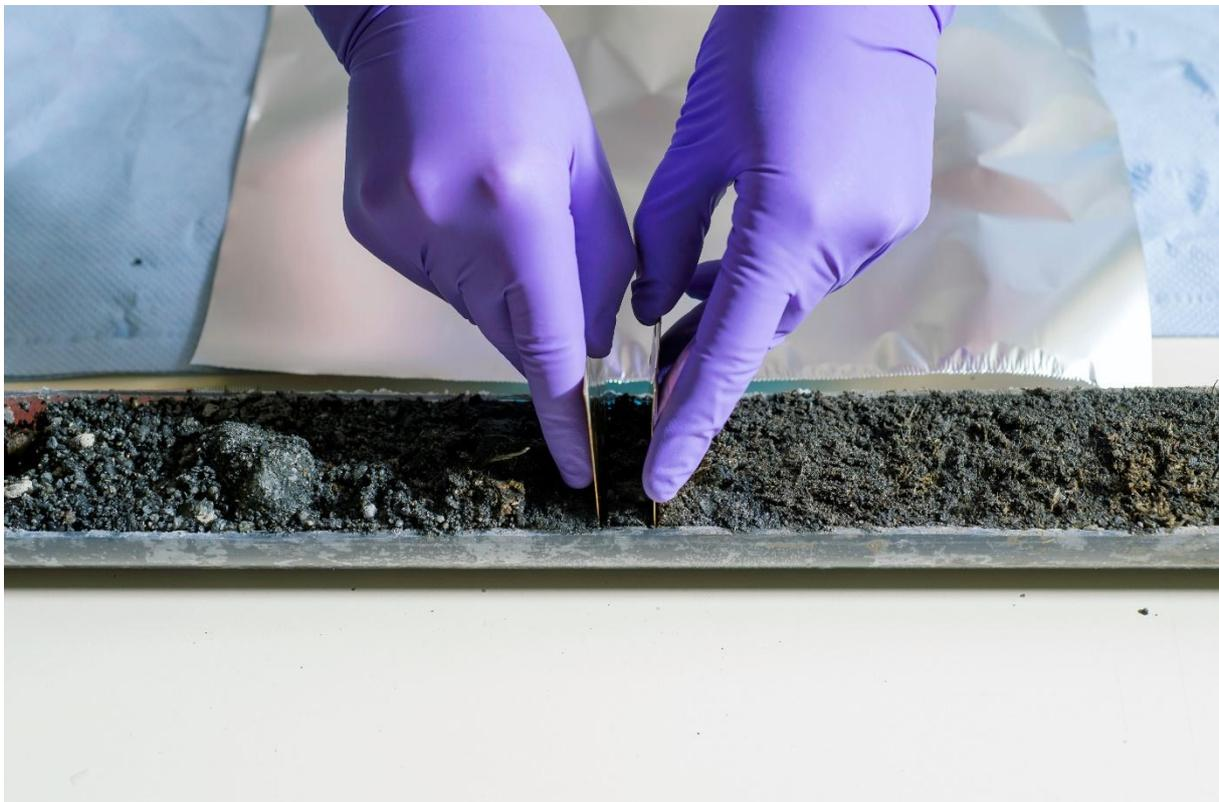
Échantillonnage d'une tranche de sédiments dans une carotte prélevée dans la chambre à sable. ©Cyril Frésillon, CNRS IMAGES
