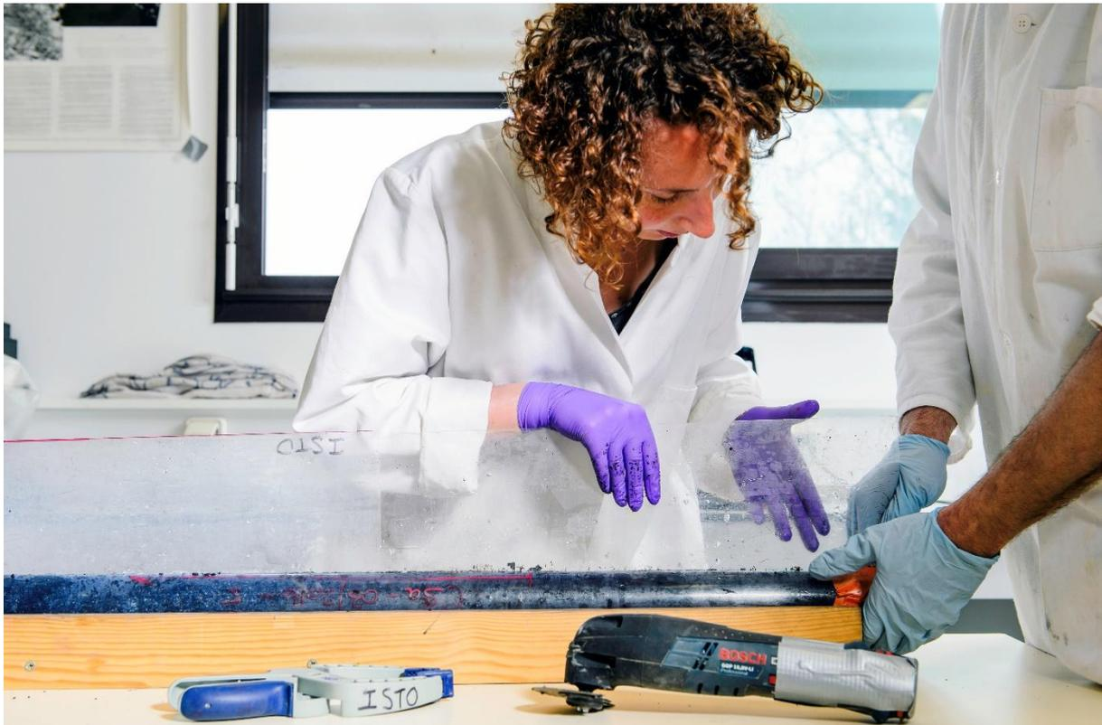
Découpe longitudinale d'une carotte sédimentaire prélevée dans la chambre à sable, avant son analyse à l'Institut des Sciences de la Terre d'Orléans (ISTO). ©Cyril Frésillon, CNRS IMAGES
