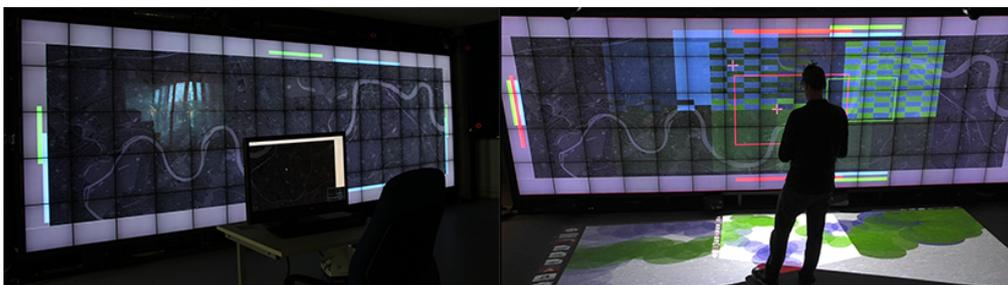
**FIGURE 4.** (gauche) Notre environnement multi-surfaces composé d'un mur d'écrans et de stations de travail (dont un visible sur la photo). (droite) Trois techniques de conscientisation de l'espace de travail : Barres d'observation sur les bords du mur, zones d'activités sur le mur et traces des utilisateurs projetés au sol.
