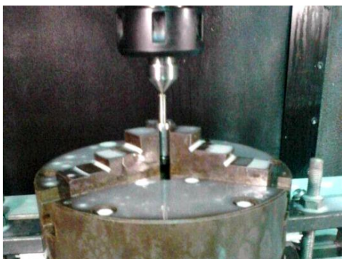
Figura 3. Centralização por furo de centro
