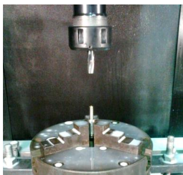
Figura 4. Detalhe da ferramenta e do CP preso com a peça bipartida
