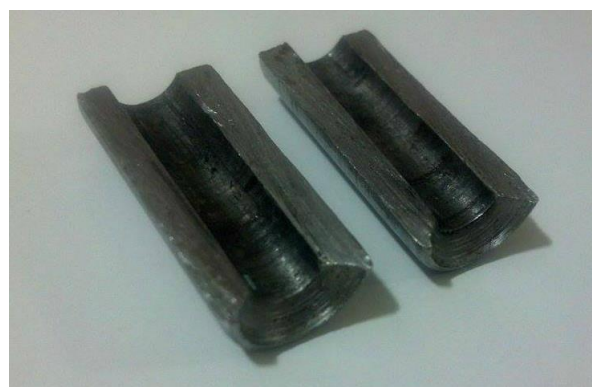
Figura 2. Peça de fixação bipartida
